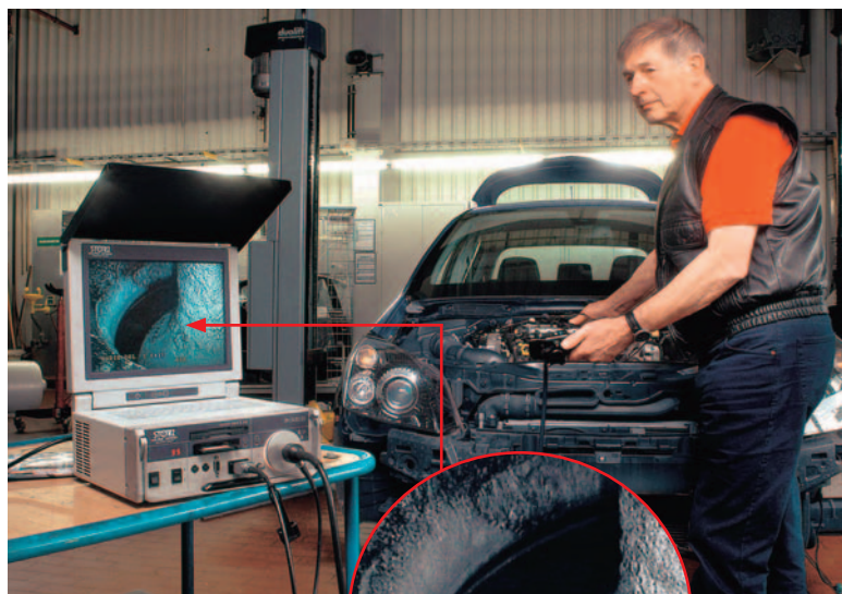
Dowód wykonanych prac: ślady endoskopu na wosku ochronnym
